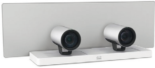
Les systèmes de suivi automatique de visioconférence ici Cisco et Polycom, utilisent 2 caméras, l'une cherche le nouvel intervenant pendant que l'autre fait un plan large. La matrice de micro associée, permet la détection de la zone d'origine de la parole. © Cisco et Polycom
