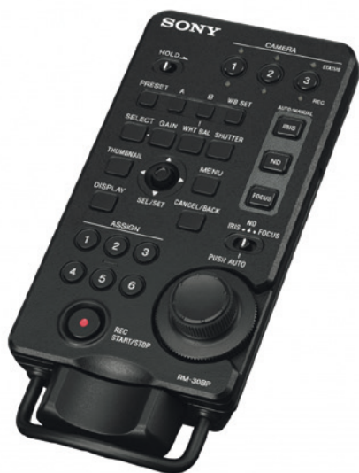
La télécommande RM-30BP regroupe à la fois les réglages de l'objectif et du signal vidéo. Elle pilote jusqu'à trois caméras. © Sony
