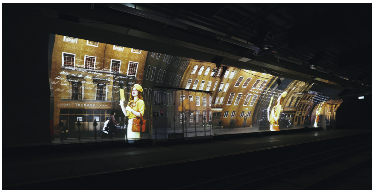
Sept projecteurs Digital Projection E-Vision Laser 8500 offrent une image de 22 mètres de long avec une résolution de 8 920 x 1 200.
