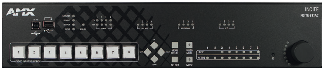
La face avant du nouveau système « tout-en-un » Incite, ici en version 2U avec l'automate NX-2200. © AMX
