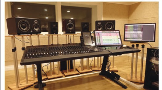
Le système Pro Tools HD Native comprend une surface Avid S6 M10 24 faders associée au logiciel Pro Tools HD, à une interface Avid Audio HD Madi et au module Avid XMON qui gère le monitoring 5.1. © B Stefani
