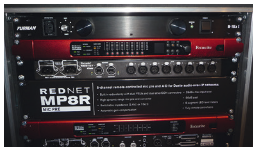
Une interface en Dante et un contrôle distant possible pour ce préampli micro Focusrite. © Antoine Gruber
