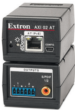
L'AXI 02 AT, une interface audio compacte qui extrait deux canaux d'un réseau audio Dante.
