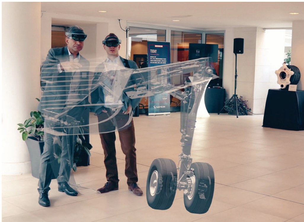
Développée par Actimage, l'application en réalité mixte Safran Landing Gear Visualizer pour l'HoloLens permet de manipuler de nouveaux modèles de trains d'atterrissage. © Actimage
