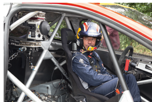
Maintenue dans un système anti-vibration, la caméra Red Helium, munie d'une optique Entaniya, est placée sur le siège du co-pilote. © Fraymedia, Futuroscope
