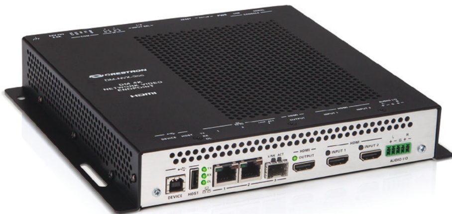
L'interface AVoIP Crestron DM-NVX-350 fonctionne au choix soit comme émetteur soit comme récepteur. Elle est équipée de deux entrées HDMI avec sélecteur et peut recevoir un module SFP pour fibre optique. © Crestron
