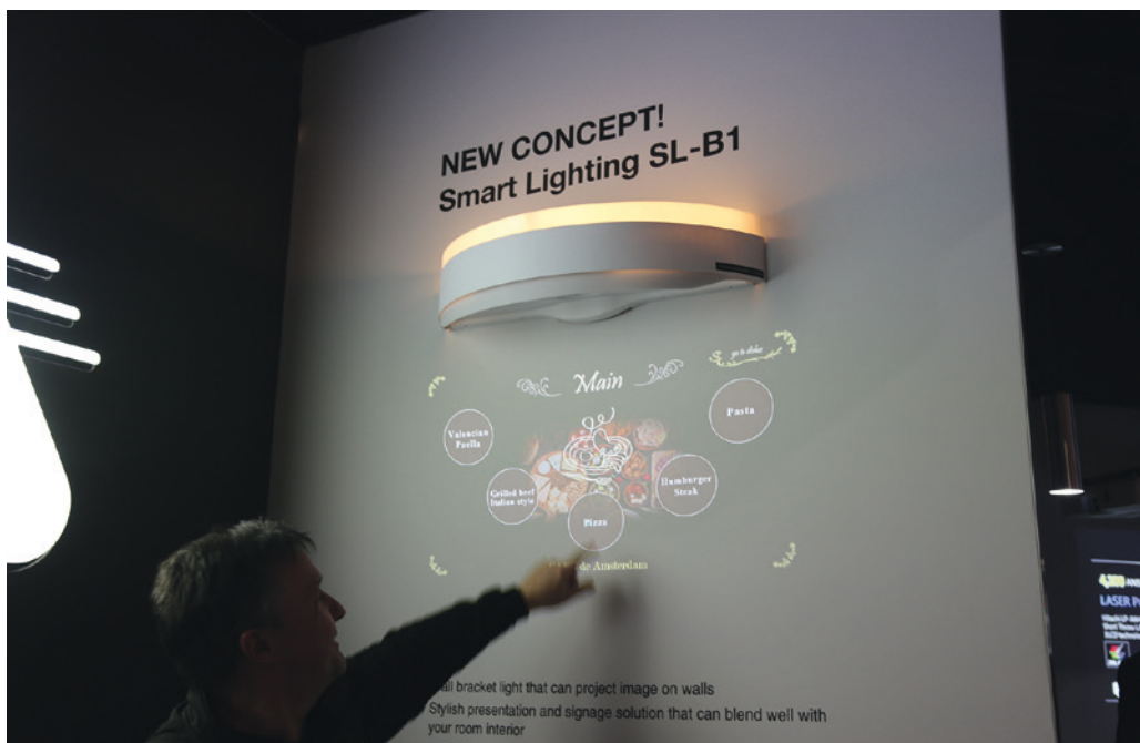
Sur le stand Hitachi on pouvait découvrir le Smart lighting SL-B1 en beta test : il s'agit d'un projecteur ultra courte focale qui ressemble à une applique lumineuse. © Nathalie Klimberg
