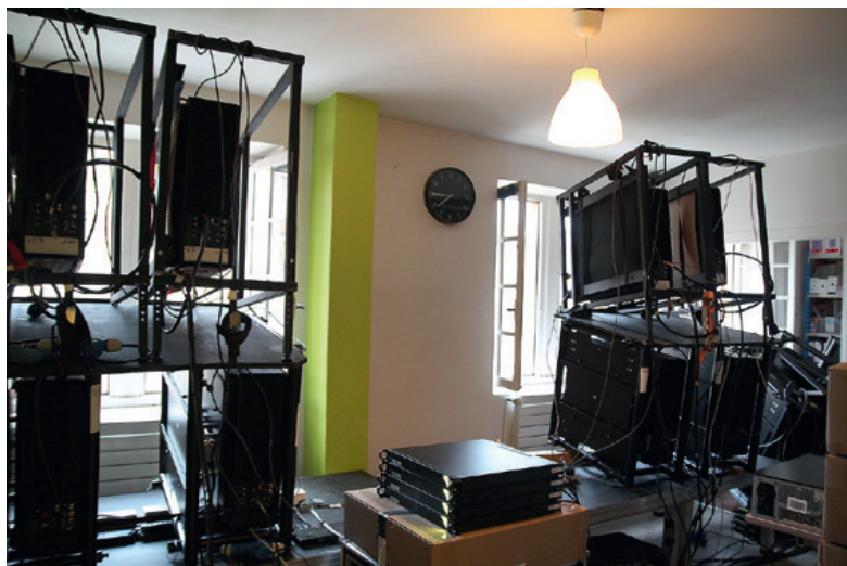
Le show nécessitait 12 projecteurs de 20 000 lums. Pour optimiser l'espace des petites salles aux fenêtres étroites, les techniciens ont dû ruser dans leur installation ! © Violaine Fouillouse
