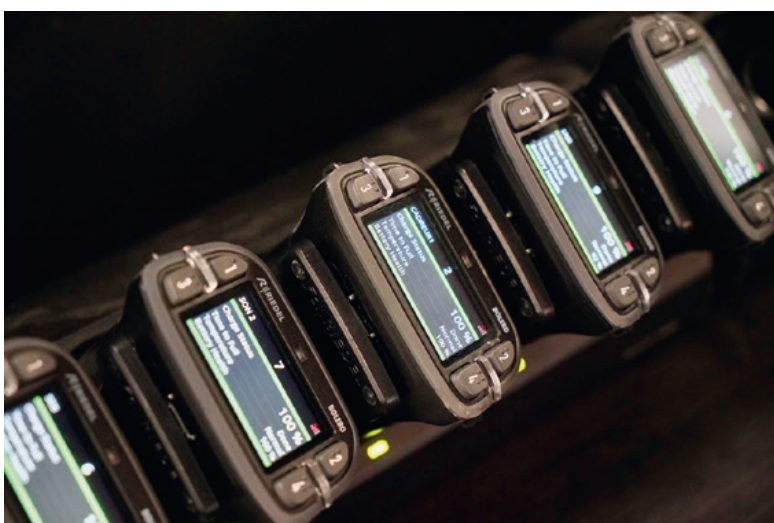
Riedel a fourni entre autres le réseau audiovisuel MediorNet, et les intercoms Bolero.
