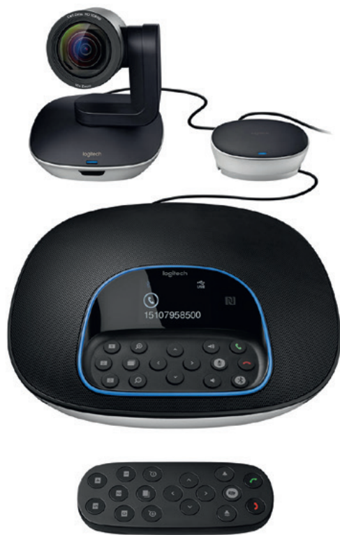
Pour les petites salles de réunion, le système Group de Logitech associe une caméra PTZ et un module audio raccordés en USB sur l'ordinateur. Le système est compatible avec Skype for Business, Bluejeans, Broadsoft, Lifesize Cloud, Vidyo et Zoom. © Logitech
