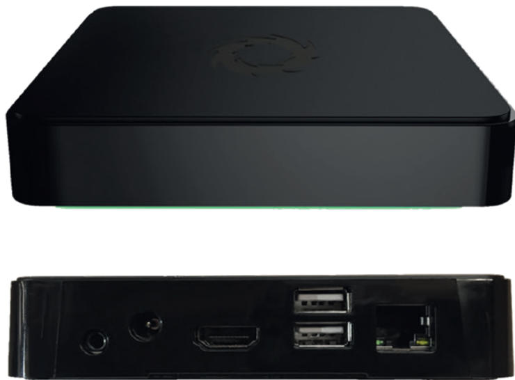
Le boîtier du Solstice, appelé Pod, comporte le minimum de connectique nécessaire.
