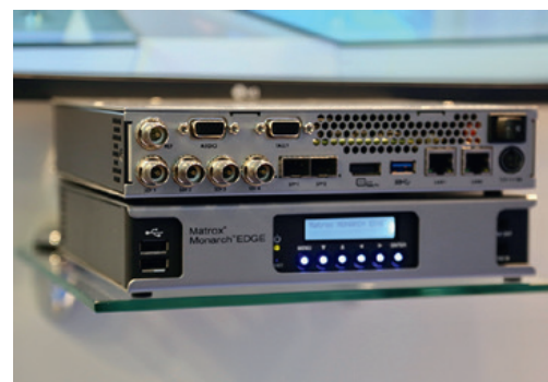
Monarch Edge, un encodeur de contribution H.264 capable de transporter de la vidéo en 10 bits 4:2:2. © Nathalie Klimberg
