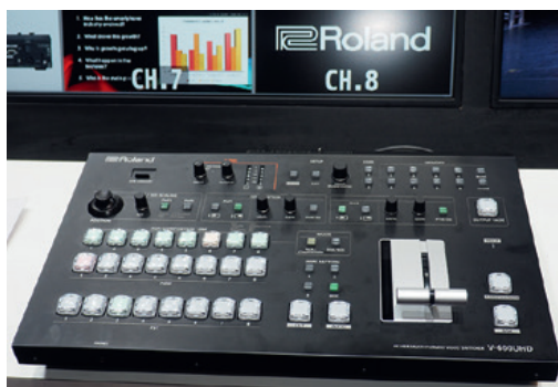
Ce mélangeur vidéo Roland 4K est équipé de connecteurs HDMI et 12G-SDI. © Antoine Gruber
