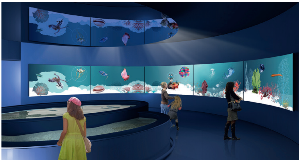
La fresque interactive, qui permet de choisir une espèce, recourt à six vidéoprojecteurs Panasonic PT-RZ 475 mis sur la tranche et trois lasers industriels de détection de mouvements. © Atelier scénographique-Pascal Payeur
