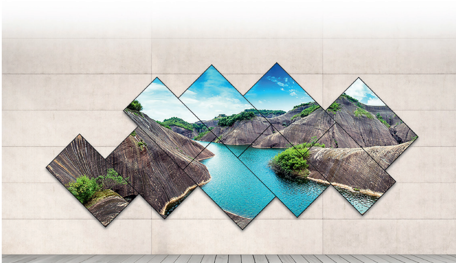
Un exemple de mur d’images totalement custom basé sur des écrans LG. Le découpage nécessite un processeur de découpe externe communiquant avec chaque écran. © LG
