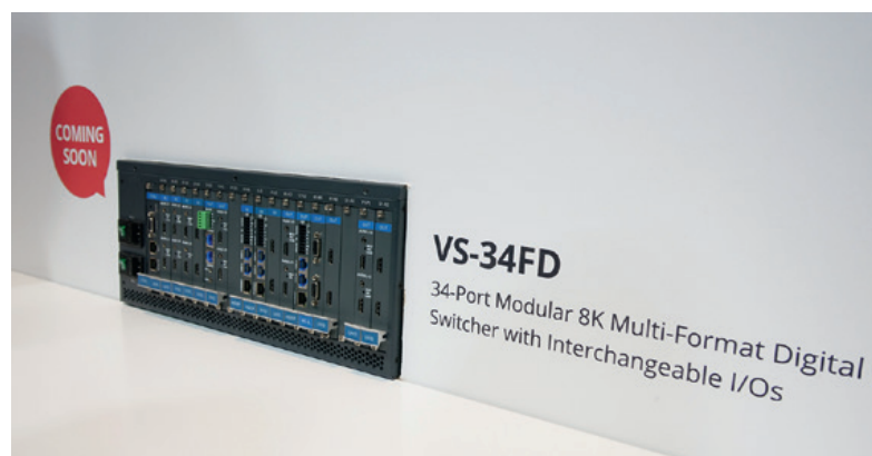
La nouvelle matrice Kramer VS-34FD supporte tous les signaux en entrées. Les sorties sont prévues en direct, en HDBaseT ou sur fibre optique. © Alban Amouroux
